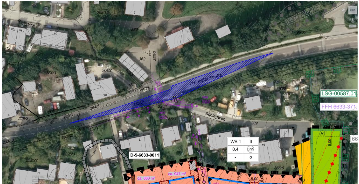
Lageplan o. M mit Darstellung Sichtdreiecke (blau) schraffierte Flächen an der Einmündung Schlagweg © Darstellung Ingenieurbüro Christofori und Partner GbR, Heilsbronn, 2026; © Luftbild und Kartengrundlage: Bay. Vermessungsverwaltung (2026)
